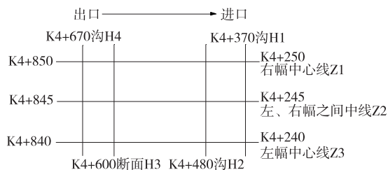
图 2 高密度电法测线布设
