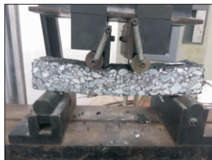
图 2 简化弯拉疲劳试验
