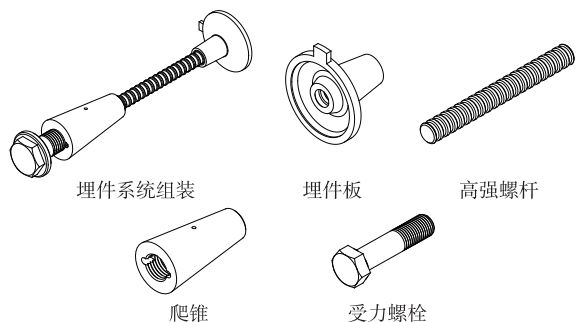
图2 埋件系统结构示意图
