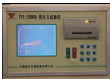
图 2 加载压力随加载时间的变化
