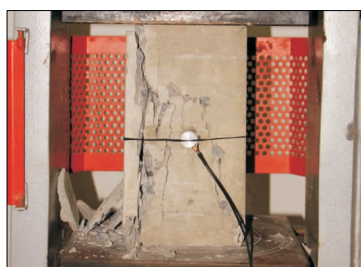
图 3 砧试件受压破坏
