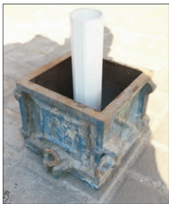
图1 声测管安装后的试模
