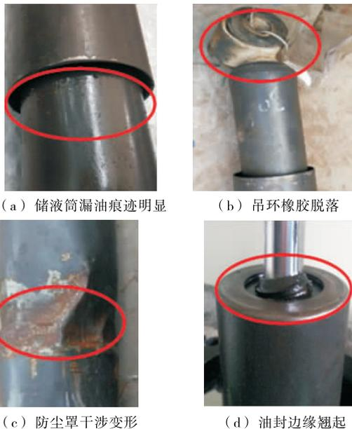
图 1 减振器常见故障模式(外观检查)
