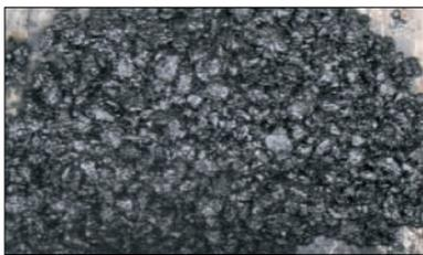
图 2 油石比 6.5% 的掺国产絮状纤维 SMA 的外观
