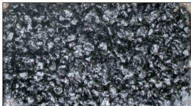
图 3 油石比 5.8% 的掺进口颗粒状纤维 SMA 的外观
