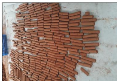
图3 水压爆破技术使用的炮泥
