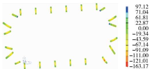
图 12 拼装平台梁应力云图(单位:MPa)
