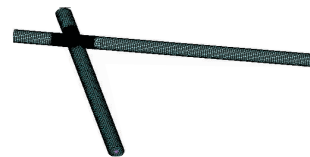
图 5 钢管撑 X 节点有限元模型
