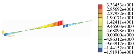
图4 主梁最大剪应力包络图(单位:MPa)
