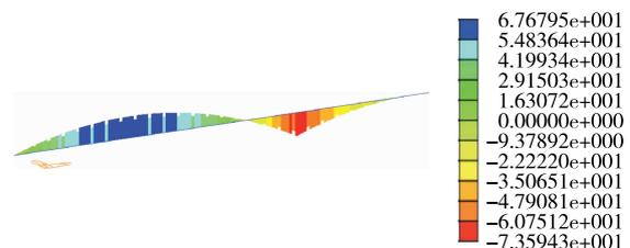
图 3 主梁最大正应力包络图(单位:MPa)
