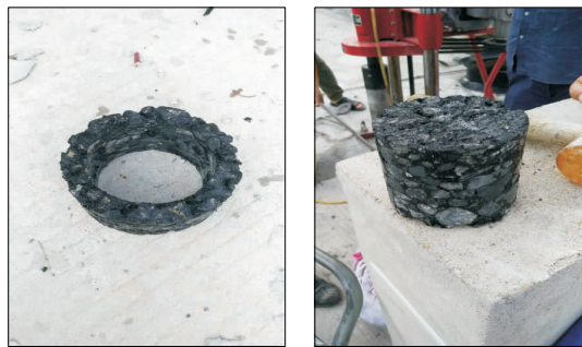
图 3 大型马歇尔击实试件和钻芯试件
