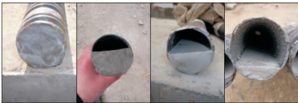
图7 不同密实程度的波纹管
