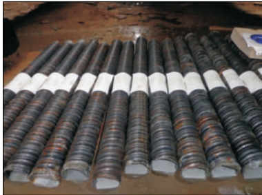
图8 试验波纹管的养护
