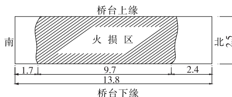
图 2 左幅 2# 桥台火损区域示意图(单位: m)
