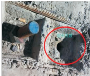
图 1 竖向预应力钢筋拉断失效
