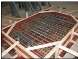
图 6 砼箱梁模型试件
