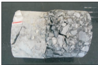
图6 剪切破坏后芯样
