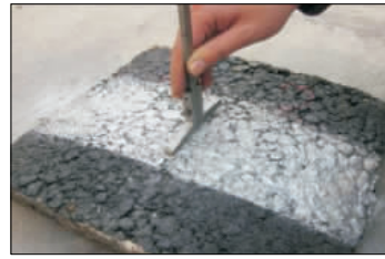
图3 人工检测试件车辙深度
