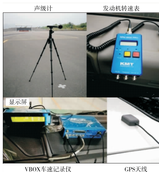
图 1 加速噪声试验设备集成
