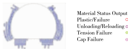
图 11 上下台阶法开挖时埋深 10 m 处围岩塑性区分布
