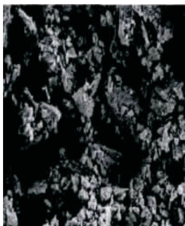
图 4 养护 28 d 钢渣稳定土的结构
