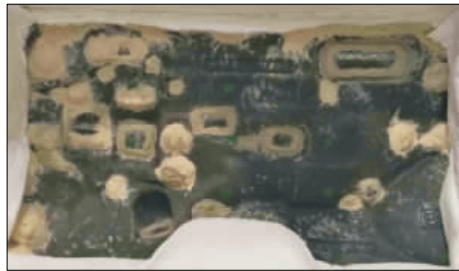
图5 内、外隔音垫密封处理
