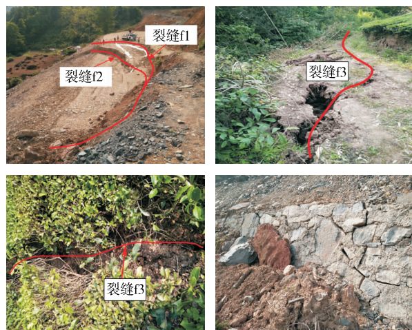
图2 滑坡区域变形破坏特征
