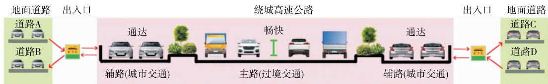
图 3 长春绕城高速公路拓宽改造断面示意图
