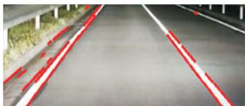
图 6 Hough 变换直线检测
