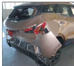
图 11 优化后实车追尾碰撞结果
