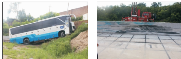
图 17 大型客车碰撞试验后车辆及护栏情况
