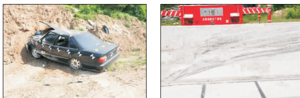
图 16 小型客车碰撞试验后车辆及护栏情况
