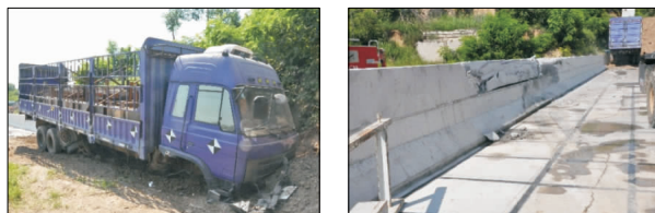
图 18 大型货车碰撞试验后车辆及护栏情况
