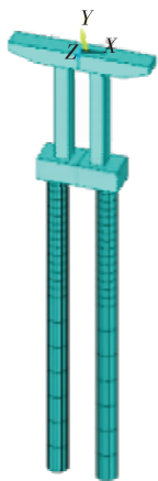
图3 节段装配式桥墩实体有限元分析模型
