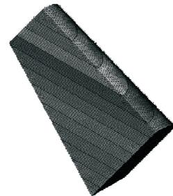
图2 1/2锚塞体水化热模型(12层浇筑)
