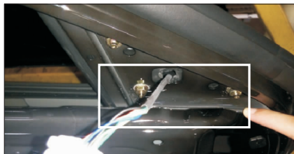
图 4 无发泡封堵
