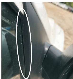
图 2 后视镜基座与车门三角钣金间的配合间隙
