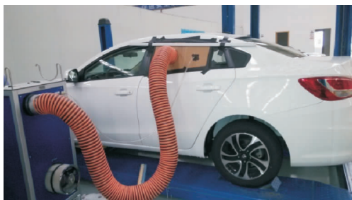
图 12 整车气密性试验台
