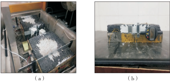
图 1 车辙仪试模拆除及固定方法
