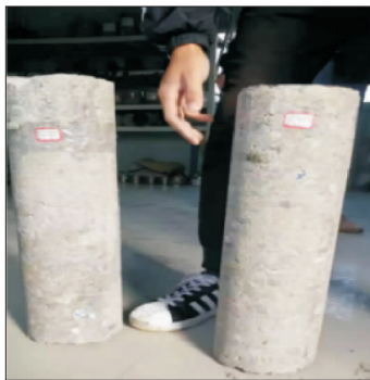
图4 注浆后水泥面板钻孔芯样
