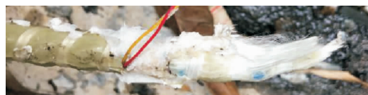
(a) 30^\circ 筋材折角断裂形态
