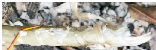
(b) 60^\circ 筋材折角断裂形态
