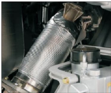
图8 铝箔保温结构
