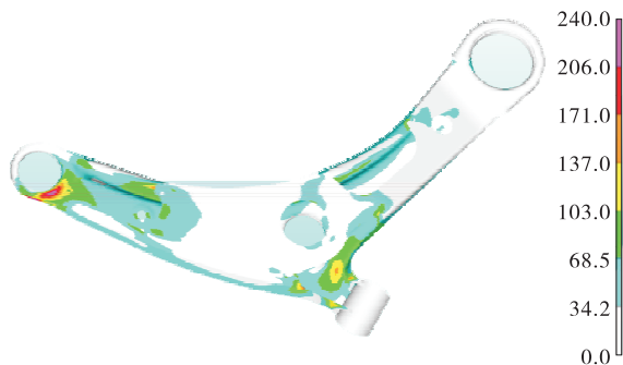
图3 下摆臂前后方向应力(单位:MPa)
