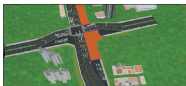
图 17 施工第 1 期车道及围挡布置
