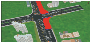
图 18 施工第 2 期车道及围挡布置
