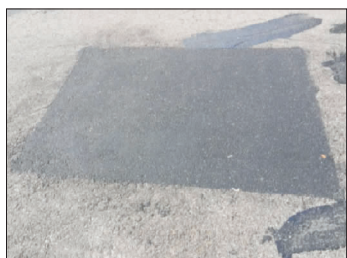
图3 反应型冷补料使用1年后效果
