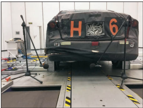
图 3 排气尾管噪声测试麦克风位置
