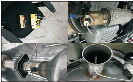
图 1 排气系统温度传感器布置
