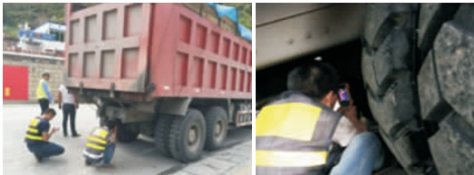
图 4 对大型车辆制动鼓温度进行检测
