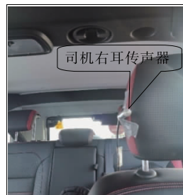
图 1 司机右耳传声器布置
