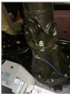
图 8 系统不平衡量振动拾取点布置
