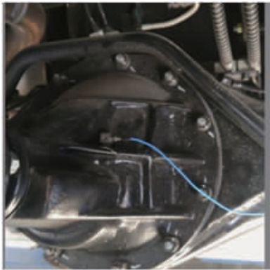
图4 后传动桥壳体振动测试
