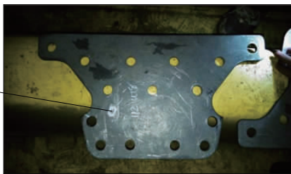
图5 补强钢板螺栓孔的调整
