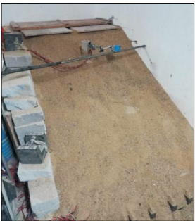
图 5 室内模型试验边坡堆积完成
