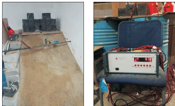
图7 室内试验加载及数据观测
