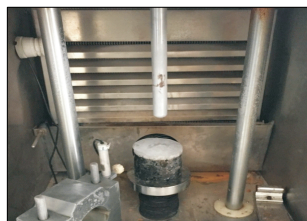
图4 SMA-13沥青混合料破冰试验现场
