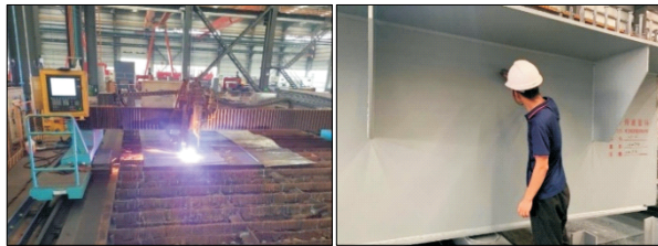
图 2 钢箱梁智能加工
