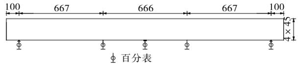
图 3 试验梁挠度测点立面布置(单位:mm)
