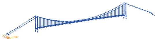
图2 棋盘洲长江公路大桥主桥有限元模型
