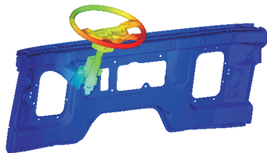
图5 增加驾驶室前围钣金加强板后的模态分析结果
