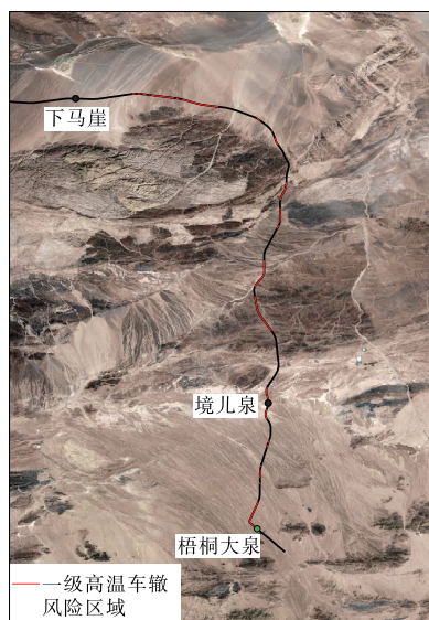
图 11 京新高速公路梧木段发生一级高温车辙风险的位置
