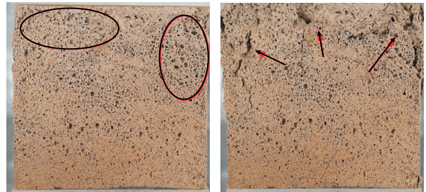
图 5 水料比过大发生串孔时孔分布与单轴受压开裂形态
